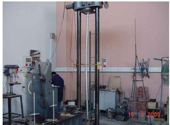
Foto 6: Falla por pandeo general del puntal.
