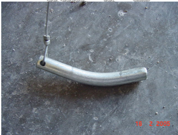
Foto 5: Pasador flectado luego de finalizado el ensayo.
