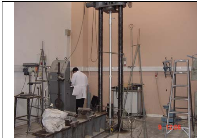
Foto 1: Vista general del ensayo de compresión de alzaprimas en posición vertical (Longitud de 2.92m).
