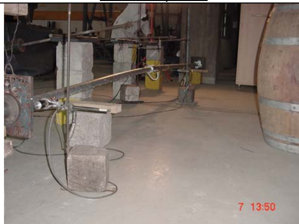
Foto 6: Deformación lateral de probeta ensayada horizontalmente.
