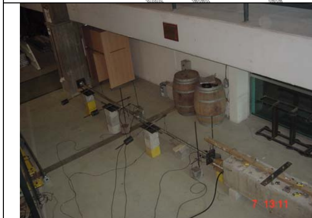
Foto 5: Vista general del ensayo de compresión de alzaprimas en posición horizontal (Longitudes mayores a 3.00m).
