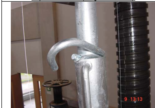
Foto 3: Detalle de deformación en sistema de regulación.
