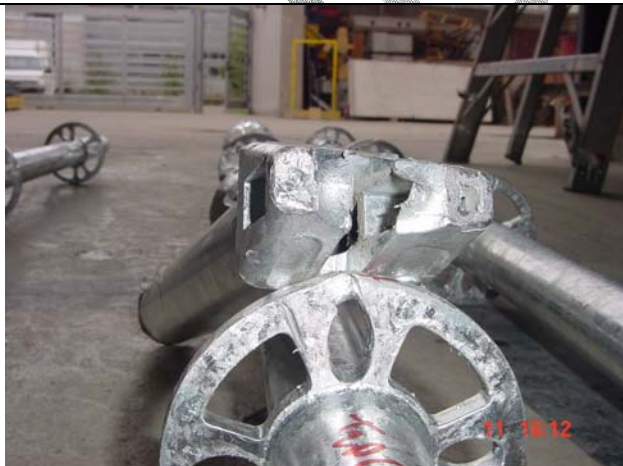
Fotografía 35: Alargamiento de la perforación en disco de empotramiento
