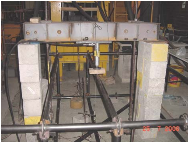
Foto 19: Vista general de montaje de ensayo de carga a barandas.
