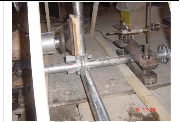
Fotografía 26: Detalle del sistema de aplicación de carga y del sistema de medición de deformaciones.
