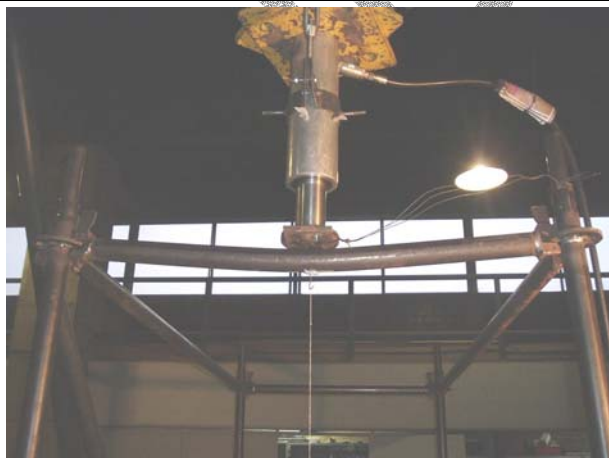
Fotografía 11: Falla por flexión de travesaño de 90cm de luz y leve pandeo de pies derechos.
