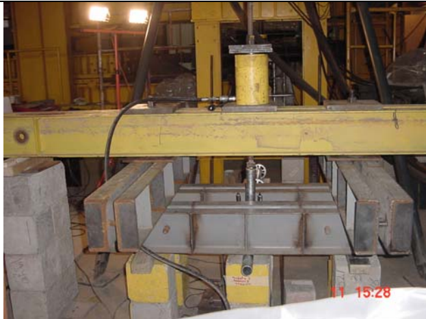
Fotografía 33: Montaje de ensayo de tracción unión pie derecho-travesaño. Vista general.
