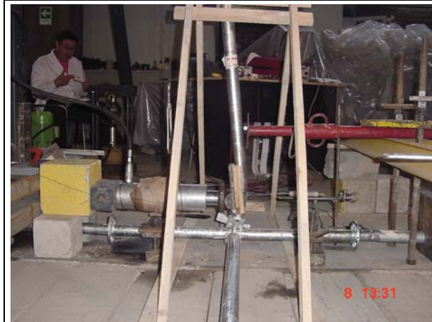
Fotografía 27: Falla por giro excesivo de la conexión.
