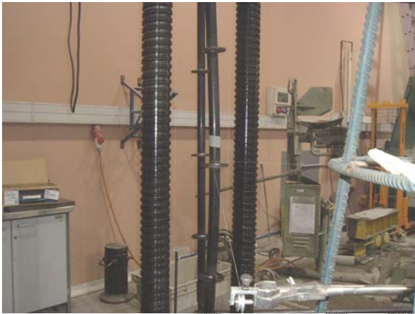
Fotografía 9: Detalle de falla por pandeo de pie derecho al final del ensayo
