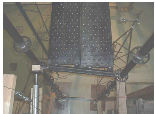
Fotografía 18: Vista superior de punto de carga durante ensayo de carga horizontal a dos cuerpos.
