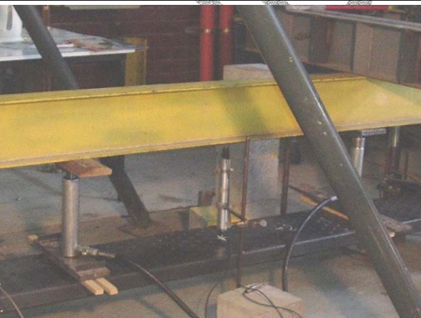
Fotografía 5: Detalle de transductor para medir deformación en tablón
