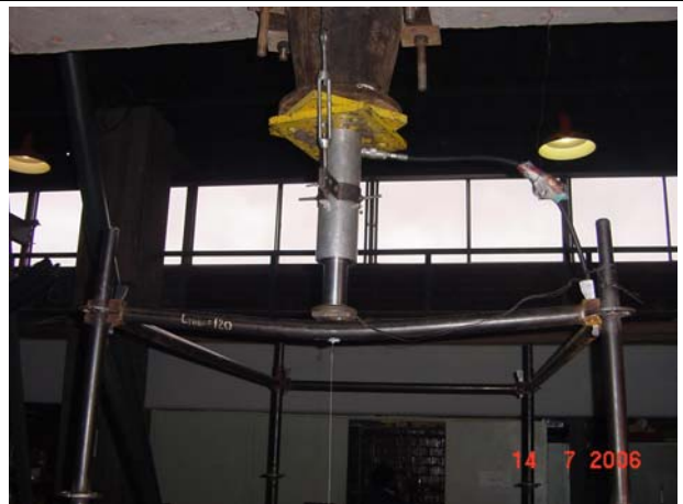
Fotografía 12: Falla por flexión de travesaño de 120cm de luz y leve pandeo de pies derechos.
