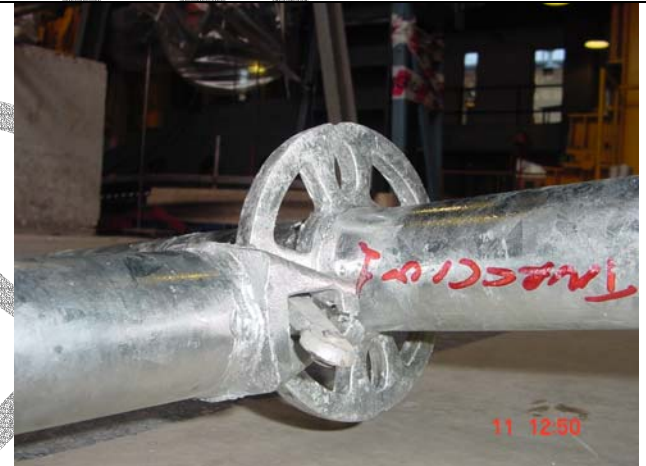
Fotografía 34: Falla del pasador y rotura de pata de fijación básica un vez concluido en el ensayo
