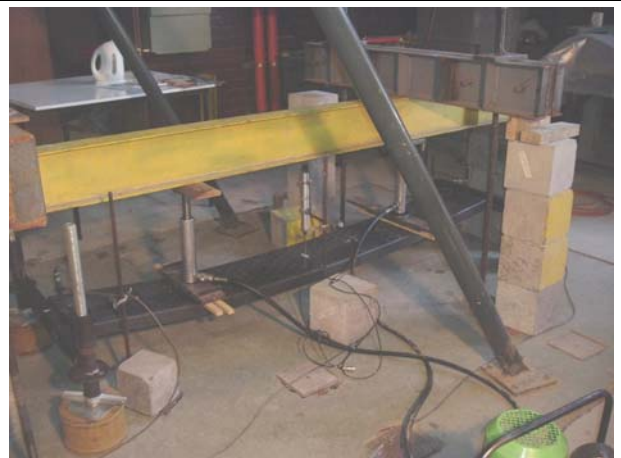
Fotografía 6: Detalle de tablón al final del ensayo de flexión simple.
