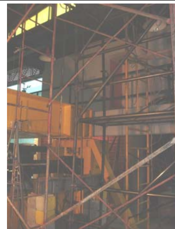
Foto 24: Vista general de falla por pandeo del sistema al final del ensayo..
