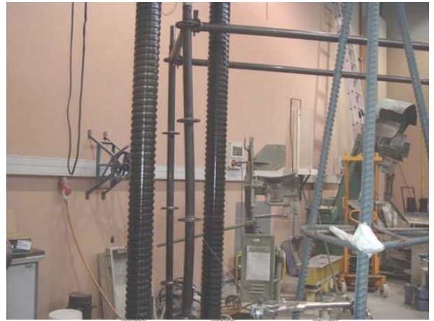
Fotografía 8: Detalle de falla por pandeo de pie derecho al final del ensayo.
