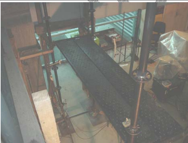
Fotografía 17: Vista general ensayo de carga horizontal a dos cuerpos de andamio.
