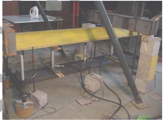
Fotografía 4: Vista general del ensayo de flexión simple a tablón metálico
