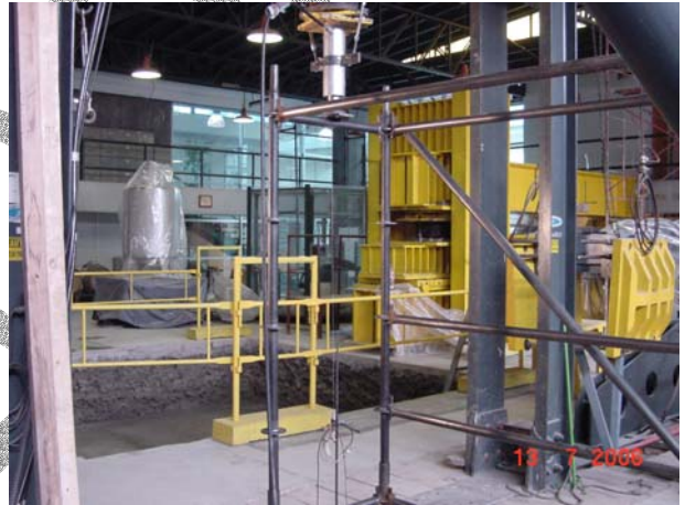
Fotografía 10: Vista general de ensayo de carga vertical a travesaño de 60cm de luz.
