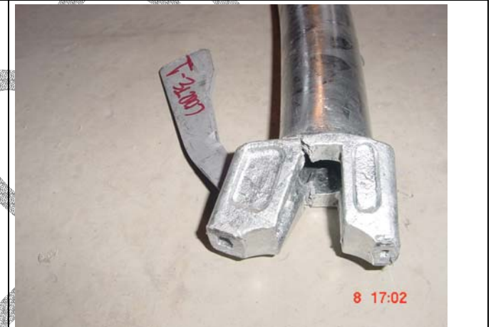
Fotografía 28: Rotura de la unión, debido al excesivo giro que se produce en la conexión.
