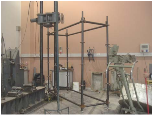
Fotografía 7: Vista general ensayo de carga vertical en pie derecho.
