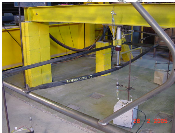
Fotografía 29: Detalle de la Baranda instantes previos a la aplicación de la carga máxima.
