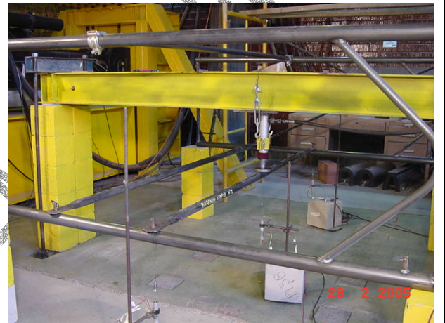
Fotografía 28: Detalle General del ensayo de flexión de Baranda
