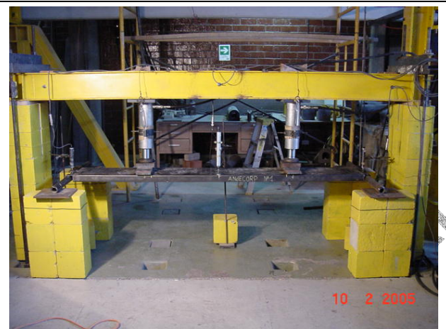
Fotografía 14: Detalle general del ensayo de flexión de Plataforma
