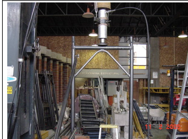
Fotografía 15: Detalle de ensayo de Carga vertical a Marco Transversal
