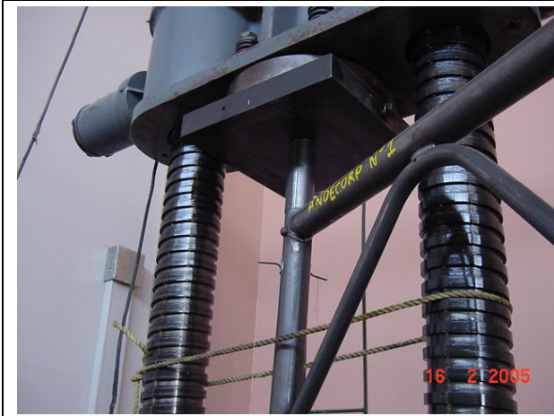
Fotografía 31: Detalle del sistema de aplicación de carga en el ensayo de carga vertical a pie derecho
