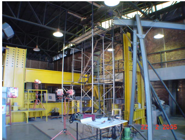
Foto 33: Vista general del ensayo de Carga vertical sobre 3 cuerpos de andamio.
