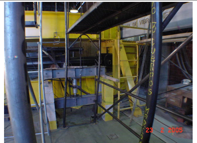
Fotografía 36:Detalle del pandeo durante el ensayo de carga vertical a 3 cuerpos de andamio.
