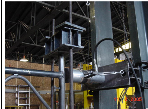
Fotografía 21: Detalle de la posición del tensor y gato hidráulico.
