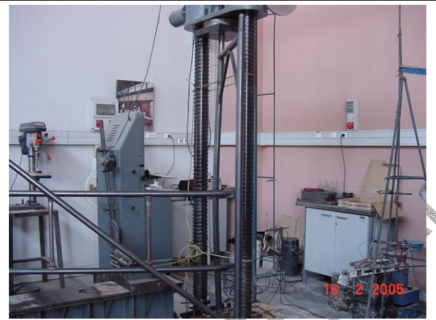
Foto 32: Probeta una vez finalizado el ensayo, se observa pandeo global.
