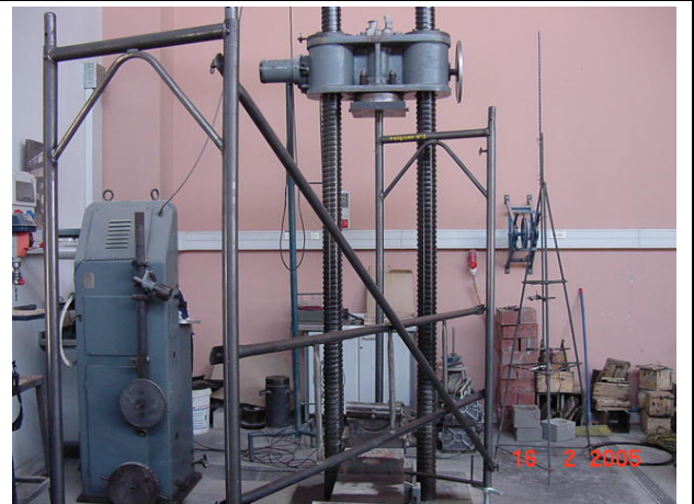
Fotografía 30: Vista general del ensayo de carga vertical a Pie Derecho
