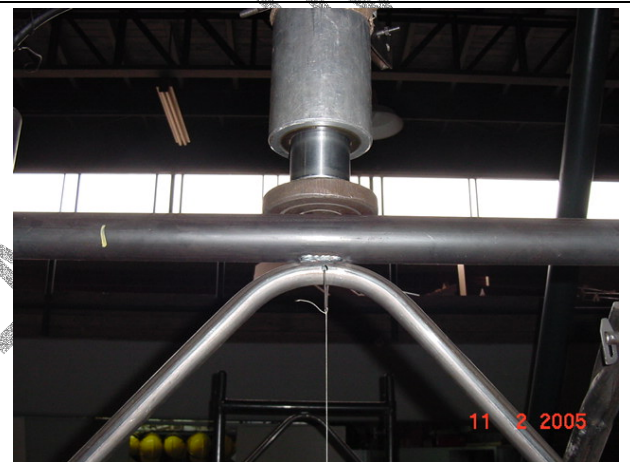
Fotografía 16: Detalle del sistema de aplicación de carga en ensayo de carga vertical a marco.
