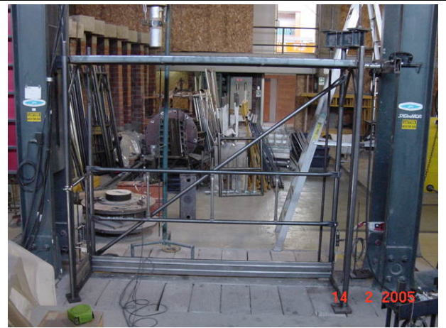
Fotografía 24: Vista General del ensayo de carga horizontal a marco longitudinal
