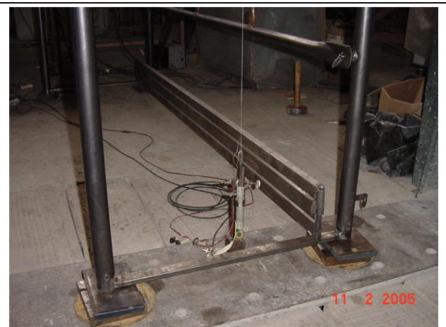
Fotografía 18: Detalle de sistema de medición de deformaciones en ensayo de carga vertical.
