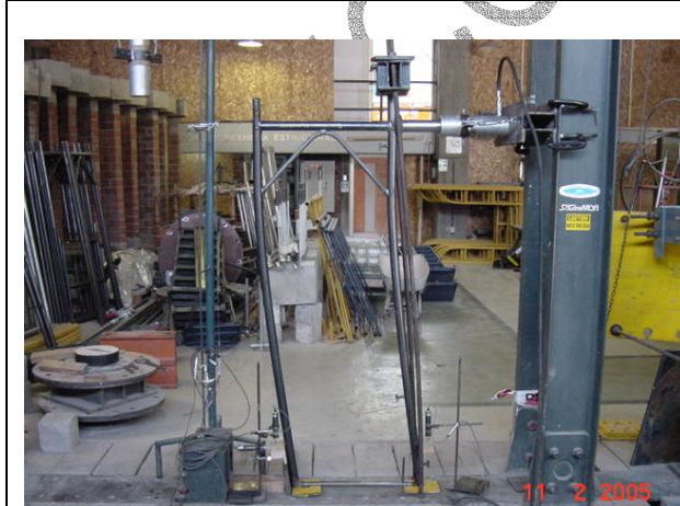
Fotografía 23: Fin del ensayo de carga horizontal en marco transversal.
