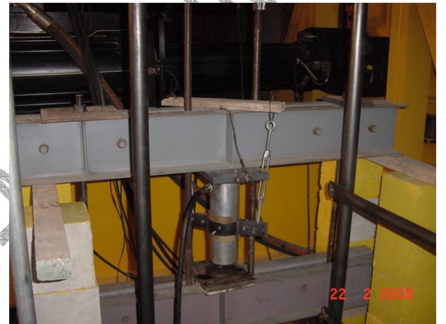
Fotografía 34: Detalle del sistema de reacción inferior y Gato hidráulico.
