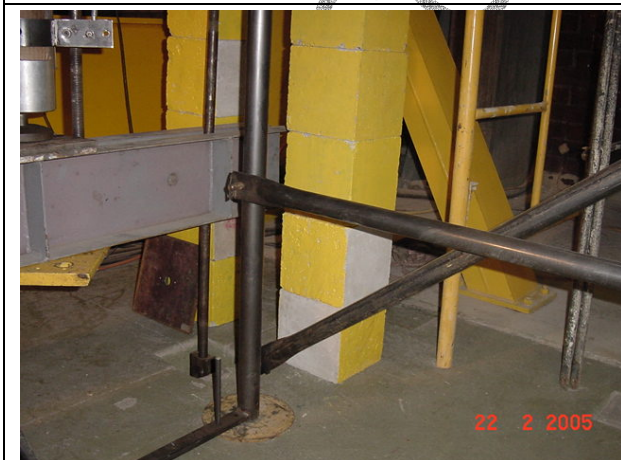
Fotografía 11: Detalle de Baranda Simple
