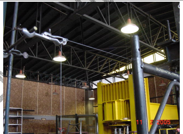
Fotografía 22: Sistema de medición de las deformaciones durante el ensayo de carga horizontal del marco transv.
