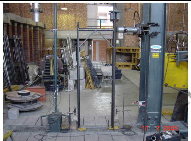
Fotografía 20: Vista general del ensayo de carga horizontal de marco transversal.
